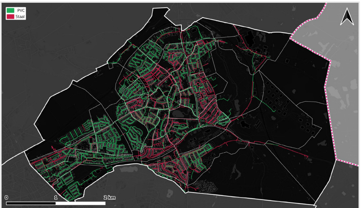
Figuur 3.4: Gasleidingen in Brunssum.
