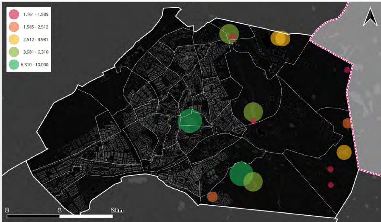
Figuur 3.2: Locaties waar warmte uit water gewonnen kan worden (aquathermie). Vennen, vijvers en beken met een potentie van minder dan 1 TJ zijn niet getoond, maar wel meegeteld in de totale potentie.
